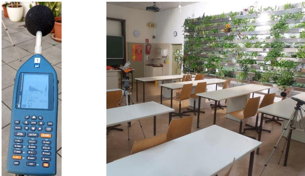
Abbildung 23: Links: Norsonic Nor140 Schallanalysator; Rechts: Drei Schallmessgeräte in einem begrüntem Klassenraum während einer Nachhallzeitmessung.
