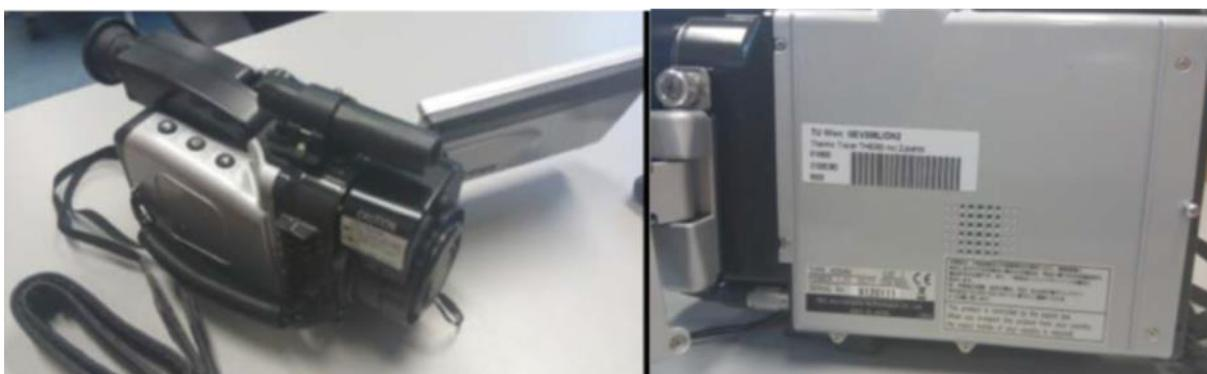
Abbildung 22: Wärmebildkamera zur Aufnahme der thermographischen Bilder.
